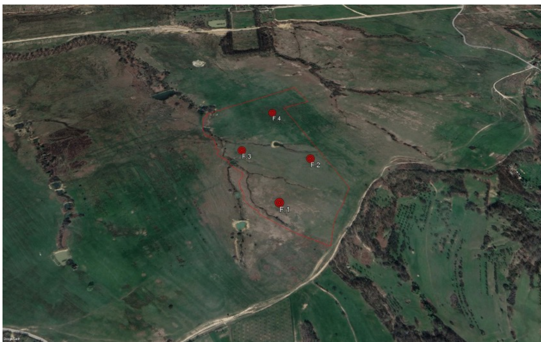
localizarea forajelor realizate în cadrul studiului geotehnic
