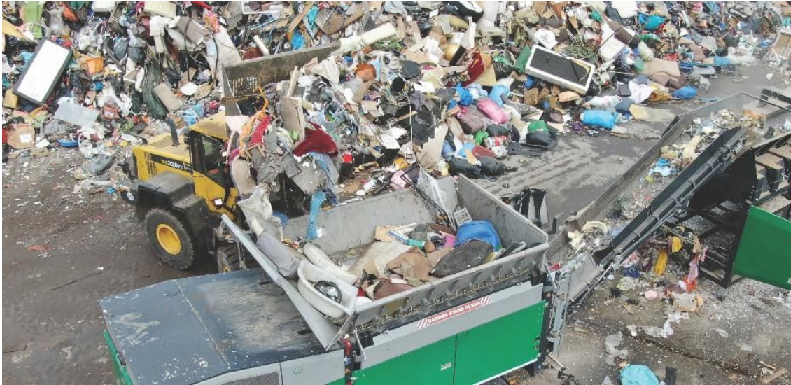
Fig.5. Tocător prelucrare deșeuri din construcții și demolări și deșeuri voluminoase
