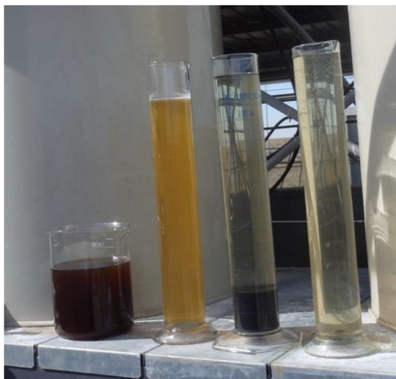
De la stanga la dreapta: efluent biologic industrial- efluent coagulare-efluent adsorbție
