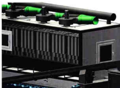
Figura nr. 26 Biofiltrul
